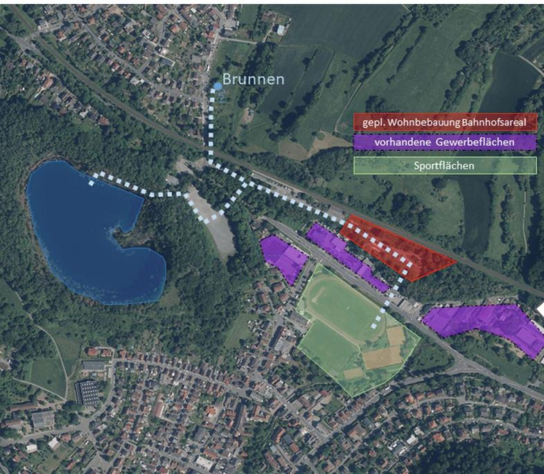
**Bild 3:** Konzept für ein separates Wassernetz zur Trinkwassersubstitution
